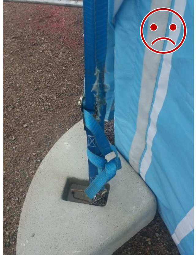
Kuva 10 EI NÄIN. Kuormaliina on kulunut.
