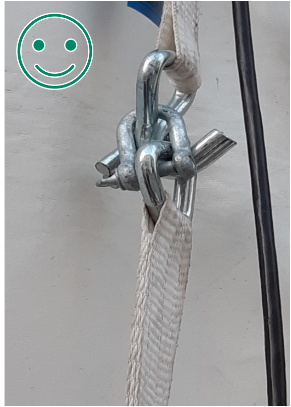
Kuva 8 HYVÄ TAPA. Koukut lukittu sakkellilla.
